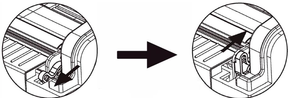
Рычаг опущен: ролик отделителя
