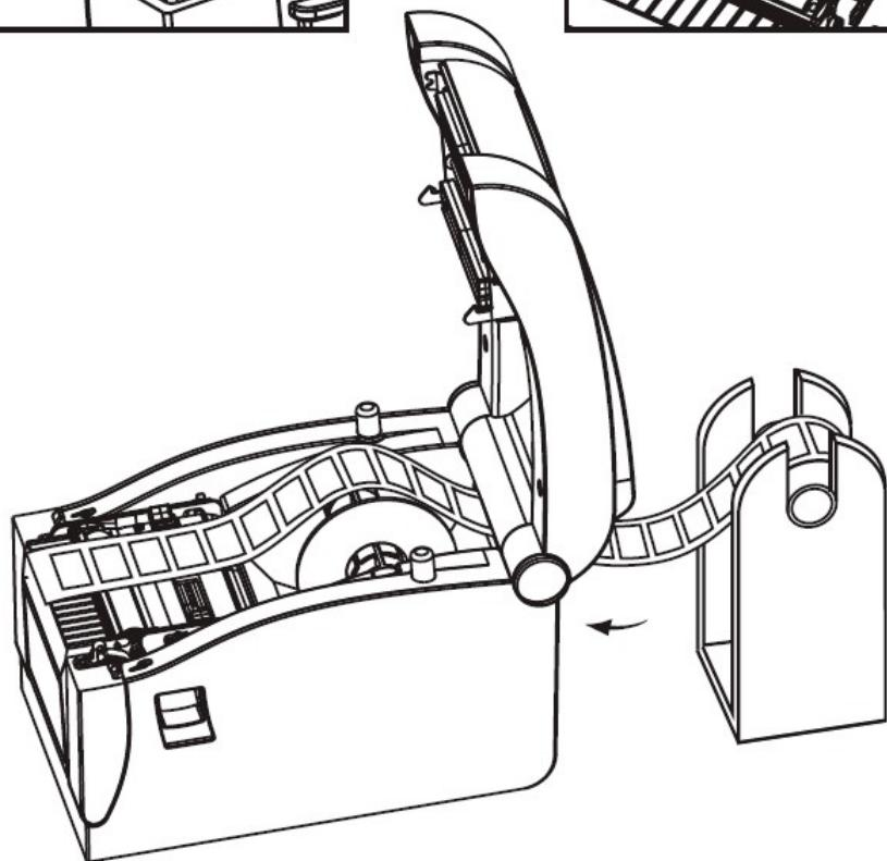
2) Опустите рычаг ролика отделения, чтобы разблокировать его.
