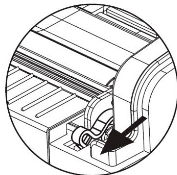
Рычаг поднят: ролик отделителя заблокирован.
